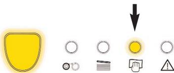
É absolutamente necessário proceder a uma limpeza depois da troca de uma cabeça de impressão.
